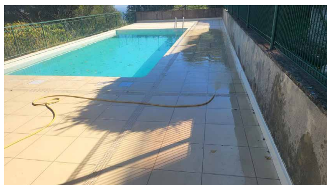
Test d'étanchéité des relevés et solins de la plage piscine : R.A.S.
